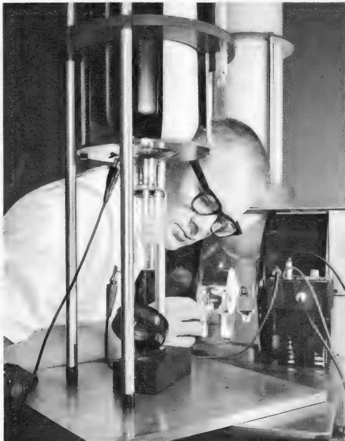
Auf die Entwicklung einer Modulationstechnik zielen die Experimente ab, bei denen das „Aufpumpen“ eines Lasers durch einen anderen versucht wird. Hier wird das Licht aus einer Laseranordnung im Hintergrund über ein Linsensystem auf eine zweite Laseranordnung im Vordergrund gespiegelt. Beide Laser befinden sich am unteren Ende von Kühlgefäßen.
