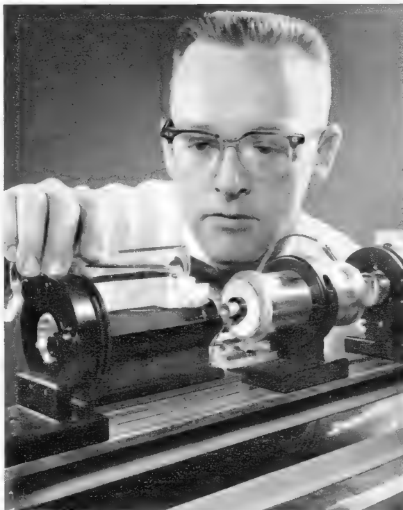
Dieses Bild aus der Anfangszeit der Laserentwicklung zeigt den – hier noch viereckigen – Rubinkristall, der in das Zentrum der mit Kühlrippen umgebenen Quecksilberdampf Lampe gesetzt wird
