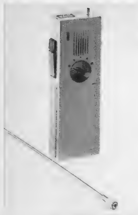
Bild 4. UKW-Kleinfunksprechgerät mit Transistorbestückung und 0,5 W Senderleistung, Modell UFT 420 (VEB Funkwerk Dresden)
